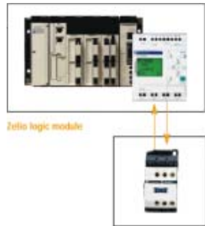
PLC, 전동기 출력으로 직접구동 가능 (100mA, 24VDC)
